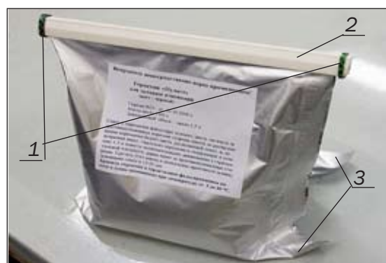
1 – фиксаторы; 2 – съемная перемычка; 3 – секции фольгированного пластикового пакета
