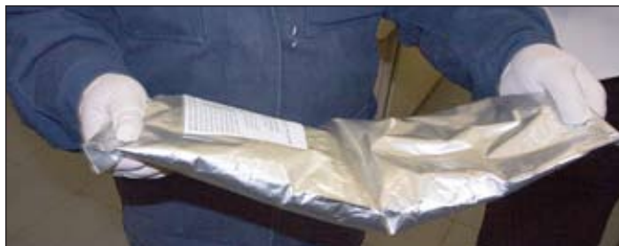
Рисунок 4.2 – Смешивание компонентов герметика в пакете
