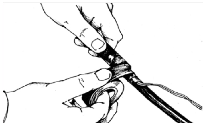
Рис. 3.2. Наложение проволочного бандажа на стальной гофрированной оболочке
